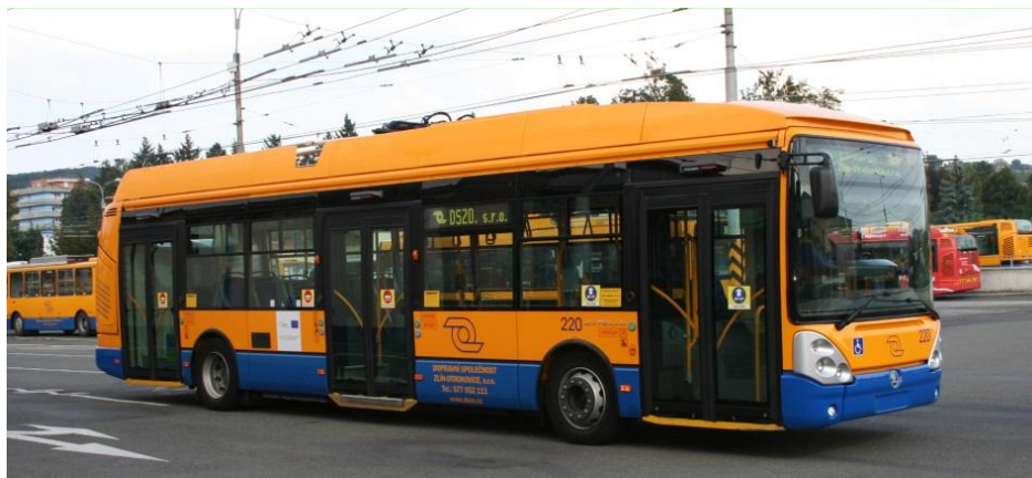
Obr. 5 Škoda 24 Tr s pomocným dieselaagregátovým pohonem [autor]
