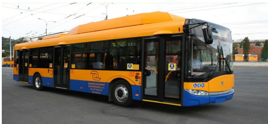
Obr. 3 Škoda 26 Tr s nLTO bateriemi [autor]
