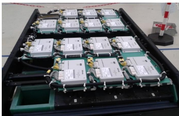
Obr. 2 Kontejner trakční baterie [autor]
