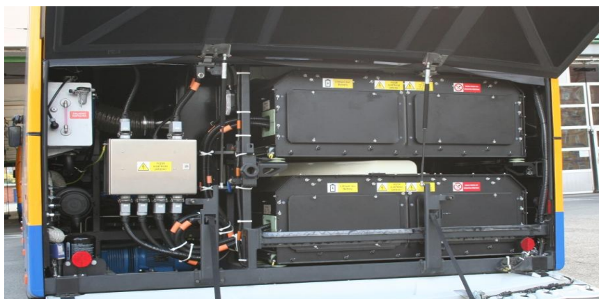
Obr. 4 Kompletní soustava trakčních baterií umístěných ve vozidle [autor]
