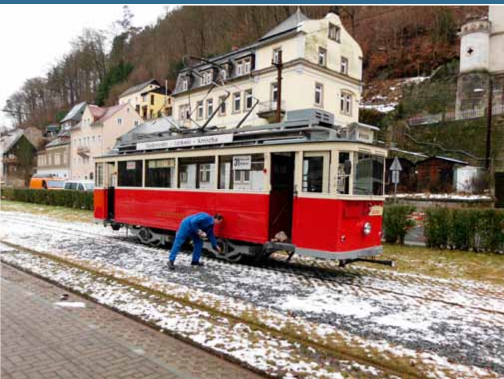
▼ První dvoukilometrová jízda vlastní silou! To byl dne 21. 1. 2012 pro členy Klubu a zaměstnance OVPS velký zážitek. Tady, na konečné zastávce „Bad Schandau“, se právě kontroluje provozní teplota nápravových ložisek. Tento vůz je poslední zachovaný zástupce typu s otočnými jednonápravovými podvozky, což byla konstrukční zvláštnost z dvacátých let minulého století. Po zrušení tramvajové trati do Kreischa u Drážďan byl vůz po dlouhém úsilí předán na křínickou dráhu jako historický.
