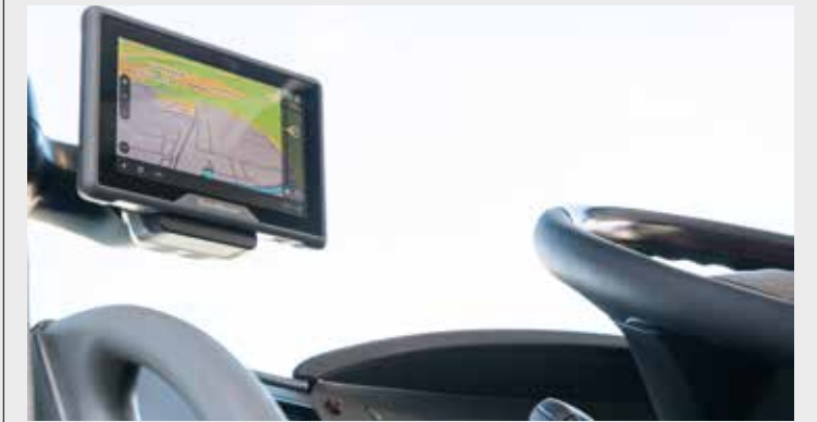
Mit der Telediagnose von OMNIplus werden im Pannenfall die genauen Standortdaten des Fahrzeugs übermittelt.
