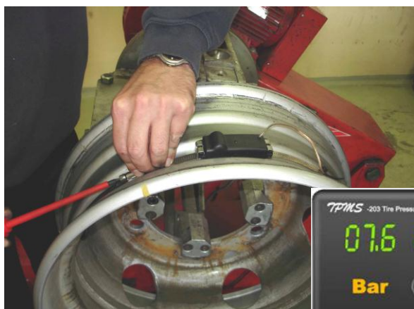
Upevnění senzoru na disk kola
